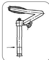
Püsttoru tuleb ohutuse tagamiseks sisestada vähemalt märgitud sügavusele, nagu on näidatud roolipostil, vt pilti. Keerake juhtraua püsttoru ülaosas asuv polt kinni.
